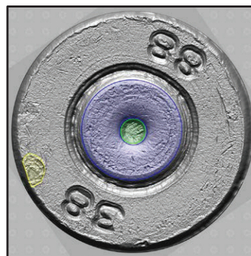
Рис. 3. Зображення слідів на гільзі, стріляної з пістолета ПБ
