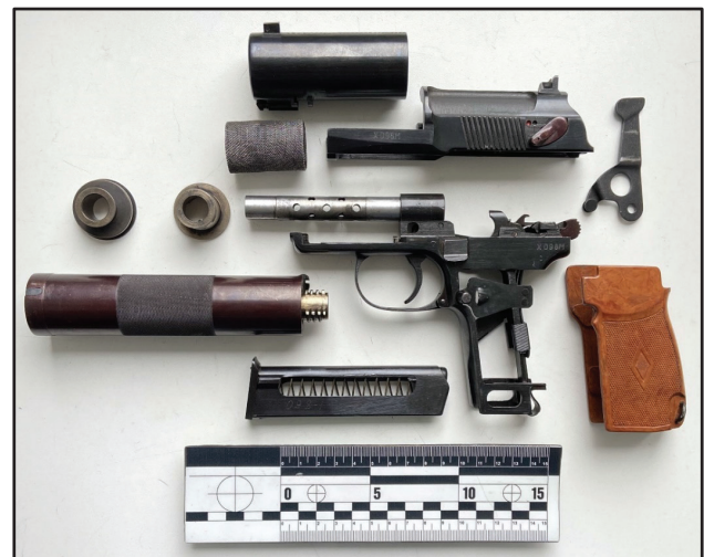
Рис. 1. 9,0-мм самозарядний пістолет для безшумної та безполум'яної стрільби ПБ та його основні частини
