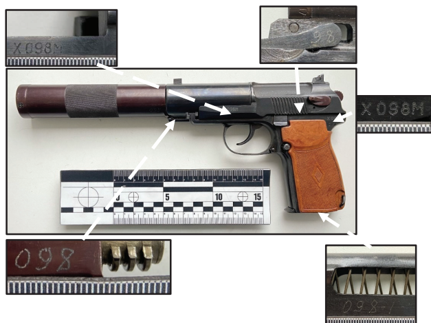
Рис. 2. Маркувальні позначення на деталях пістолета ПБ
